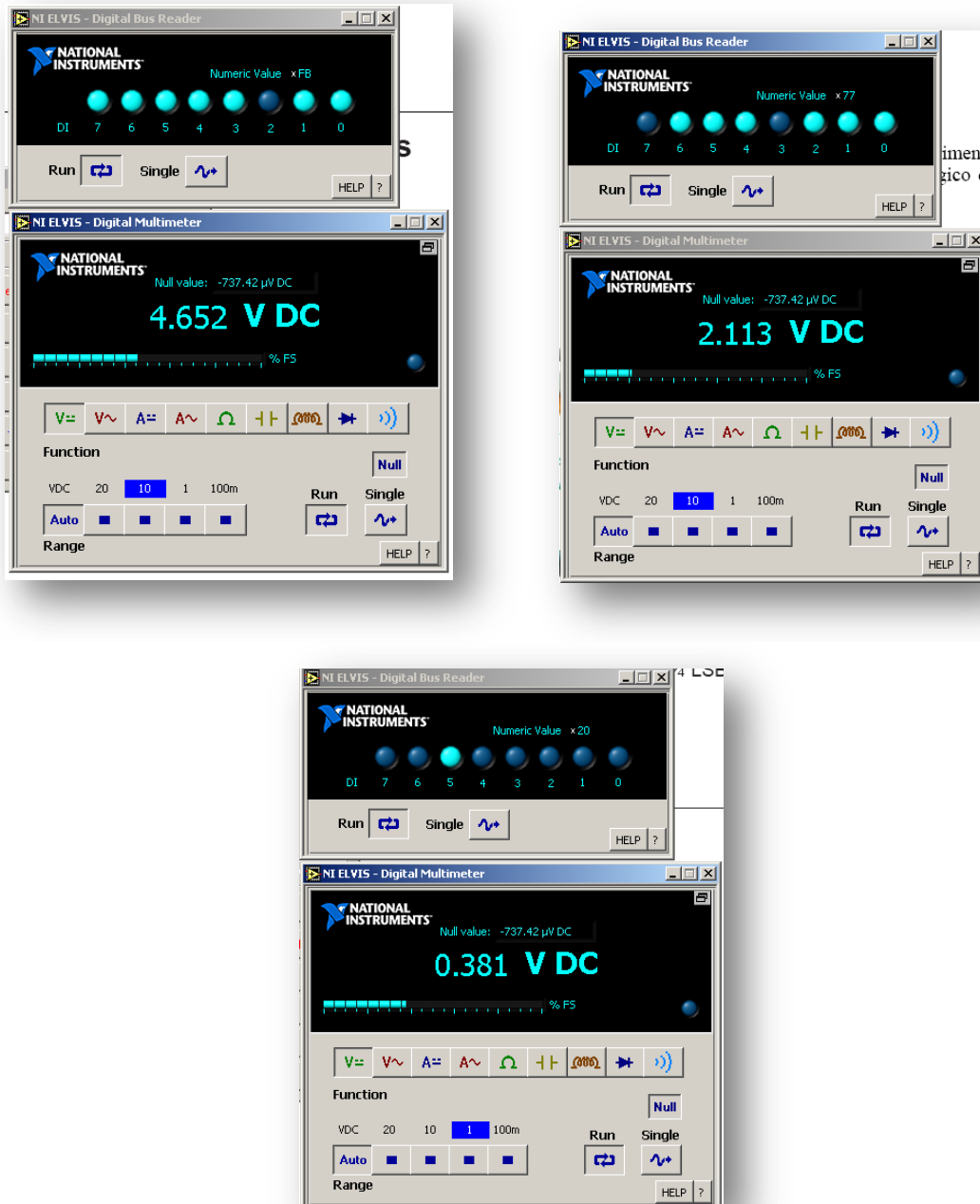
f7- 3. Imágenes de lector digital y multímetro virtual para experimento de ADC
